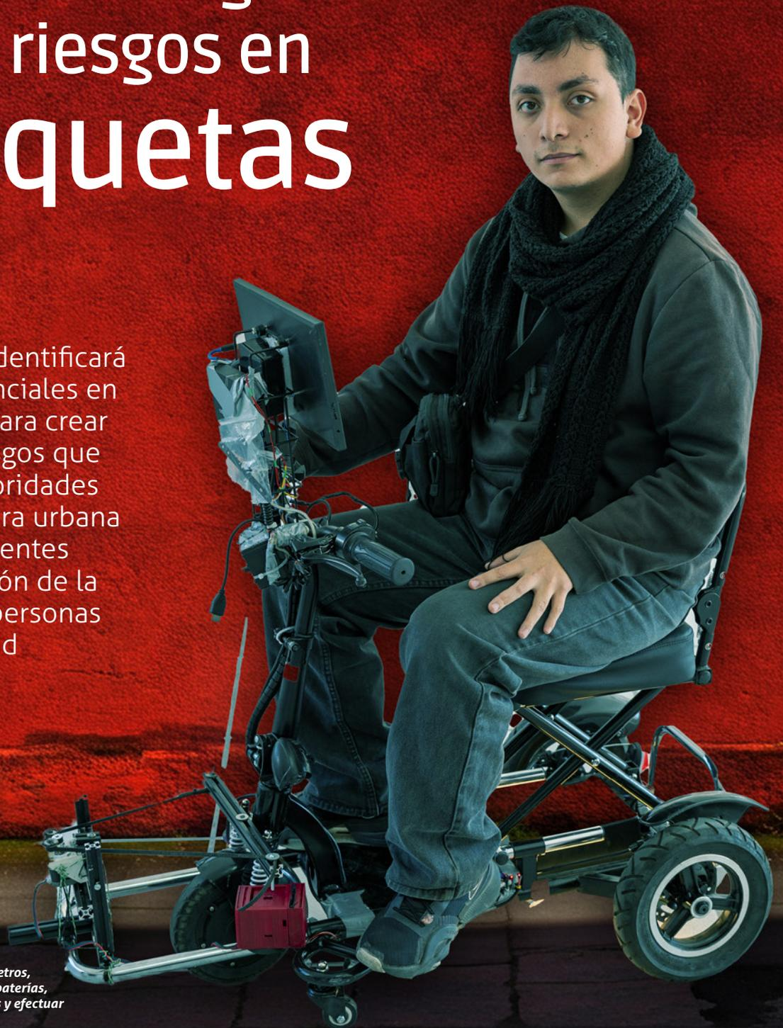
*El prototipo cuenta con acelerómetros, un giroscopio, un GPS, sensores, baterías, cámaras para recolectar los datos y efectuar el mapeo de las banquetas*
