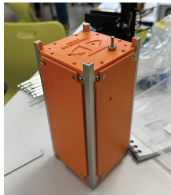
El Sistema Trinidad V3 se basa en una computadora de vuelo diseñada para capturar datos ambientales y procesamiento de imágenes de la estratósfera con apoyo de IA
