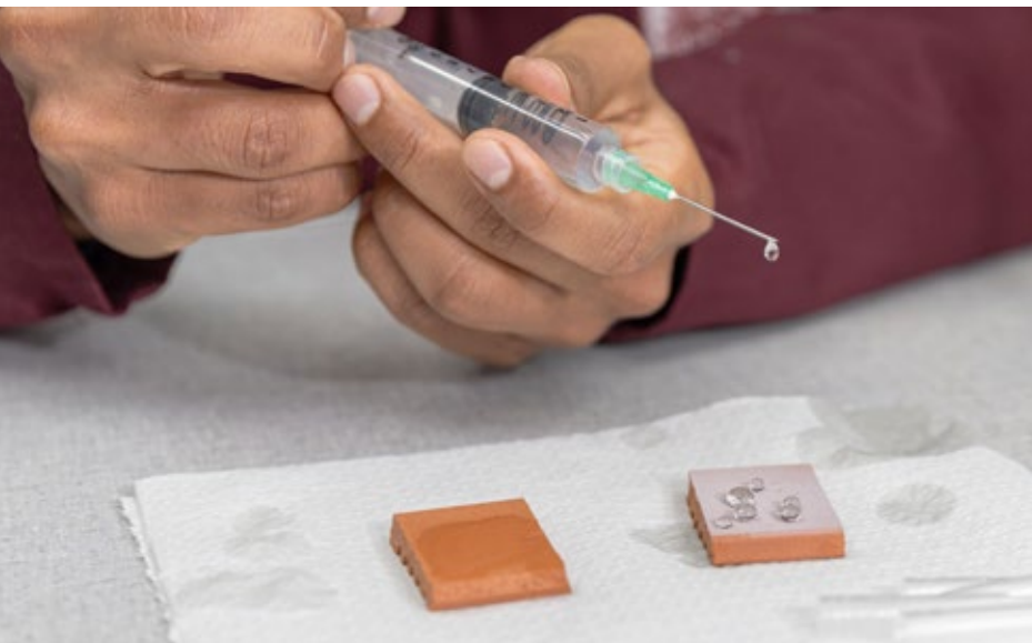
Los ensayos confirmaron que el recubrimiento mantiene sus propiedades en cerámica, vidrio y acero, entre otros materiales
