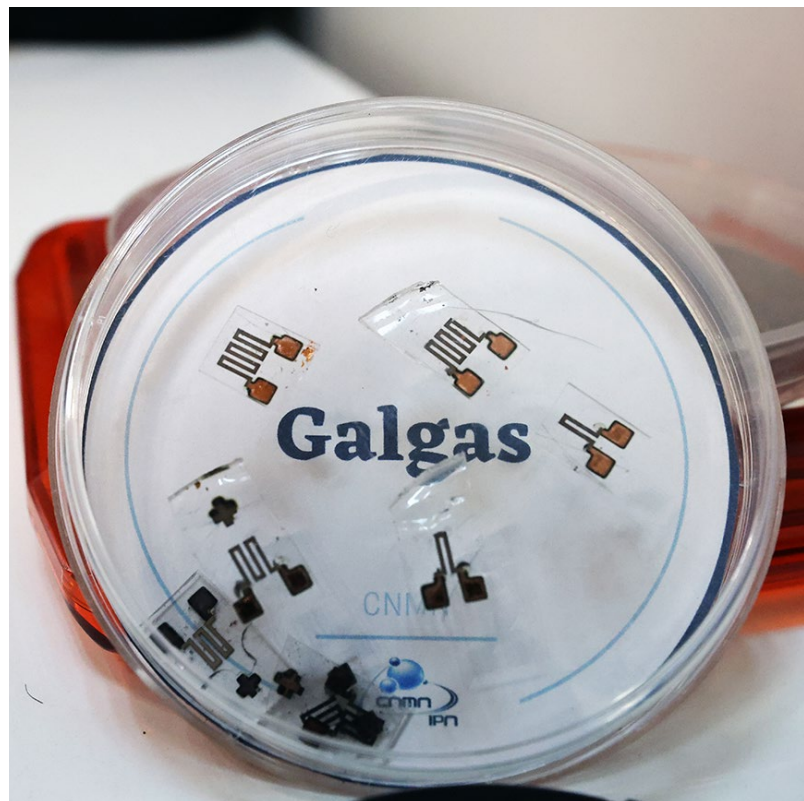
Las galgas se utilizan en el sector aeronáutico debido a que permiten monitorear el funcionamiento estructural de una aeronave
