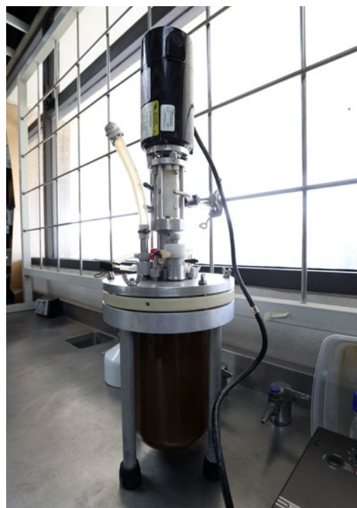
El biorreactor agita el contenido para mantenerlo homogéneo
