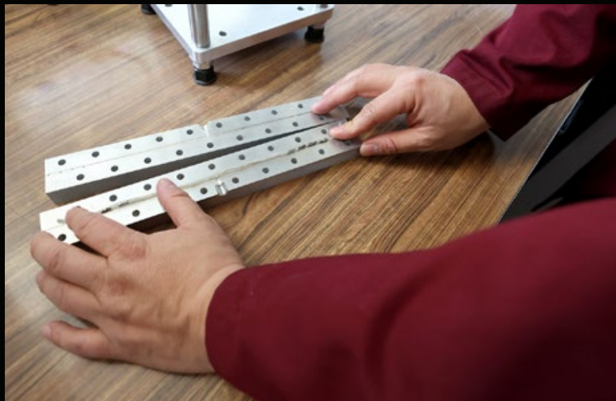
Diseñaron moldes especiales para que los electrodos tengan la misma calidad y funcionalidad que los dispositivos comerciales
