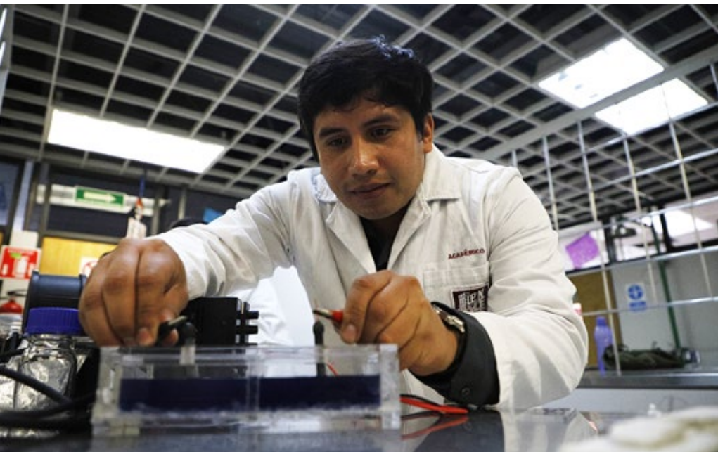
Electrodos fabricados con nanocarbono vegetal de sargazo para remover contaminantes de la industria textil
