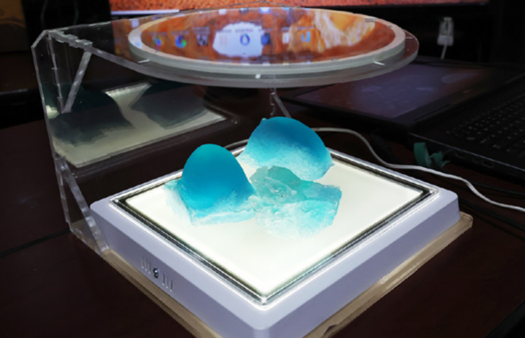
Los modelos se colocan en el polarizador para analizarlos exhaustivamente
