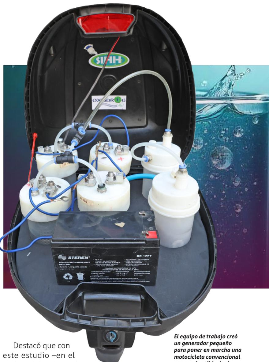
*El equipo de trabajo creó un generador pequeño para poner en marcha una motocicleta convencional con combustible dual: gasolina-hidrógeno*
