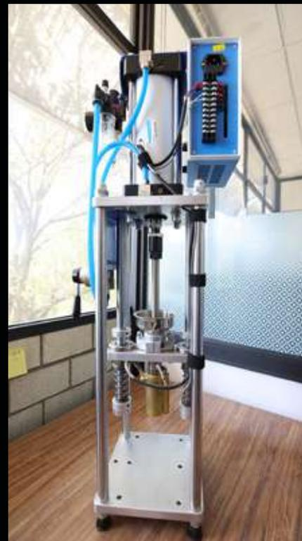
*Equipo utilizado para fabricar los electrodos*
