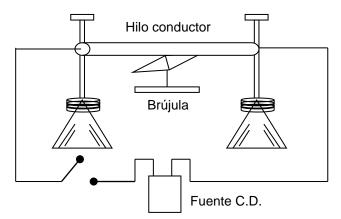
Paso 2: Aplicar una tensión de 6V y cerrar el interruptor por breve tiempo, con el fin de hacer circular una corriente eléctrica a través del conductor..
