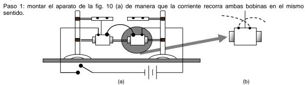
Paso 2: Haga circular una corriente eléctrica aplicando una tensión de 10 V a la bobina, y cerrar el circuito Paso 3: Repetir el experimento, pero conectando las bobinas de manera que la corriente recorra ambas bobinas en sentidos opuestos (conexión punteada). Fig. 10 (b).
