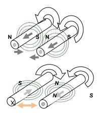
Cuando un conductor se presenta en forma de espira o bobina también producirá un campo magnético cuando por ellas circule una corriente eléctrica. Y para saber la posición de los polos en un solenoide se aplica la regla de la mano derecha así:
