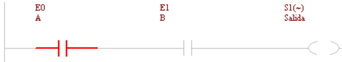
Función Lógica AND (Y) con entrada A en "0" y B en "1".
