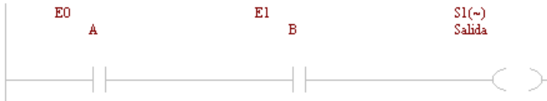
Función Lógica AND (Y) con las entradas A y B en "0".
