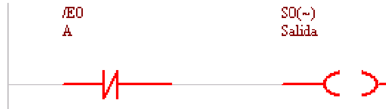
Figura 6. 5 Función Lógica Inversora (NOT) con las entrada A en “0”.
