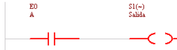
Figura 6. 7 Función Lógica NO Inversora con las entrada A en “0”.
