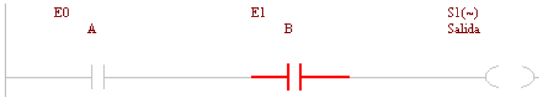
Función Lógica AND (Y) con entrada A en "0" y B en "1".
